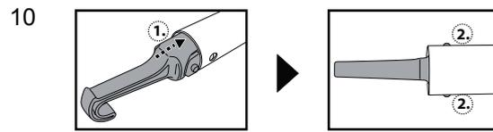
**Remarque :** Si le flotteur est trop loin pour pouvoir le récupérer à la main, utilisez le crochet fourni. Placez le crochet sur le manche télescopique (non inclus) et utilisez le crochet pour récupérer le flotteur.
