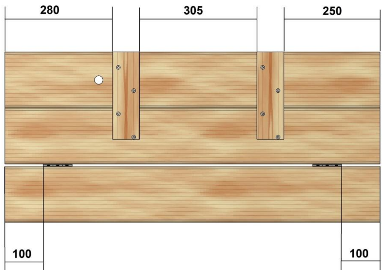
Figure 65 – Assemblage du caillebotis
