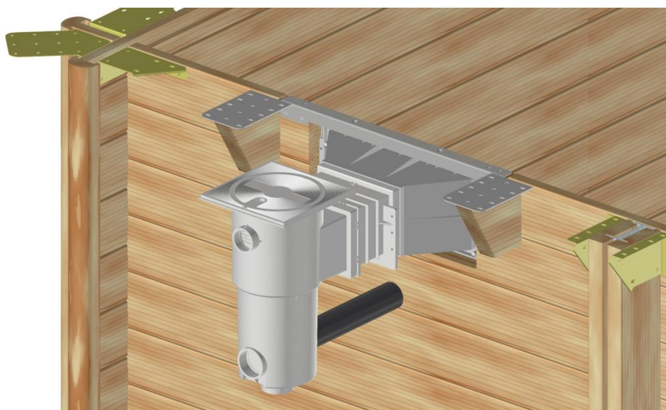
Figure 22 – Montage de l'équerre de skimmer
