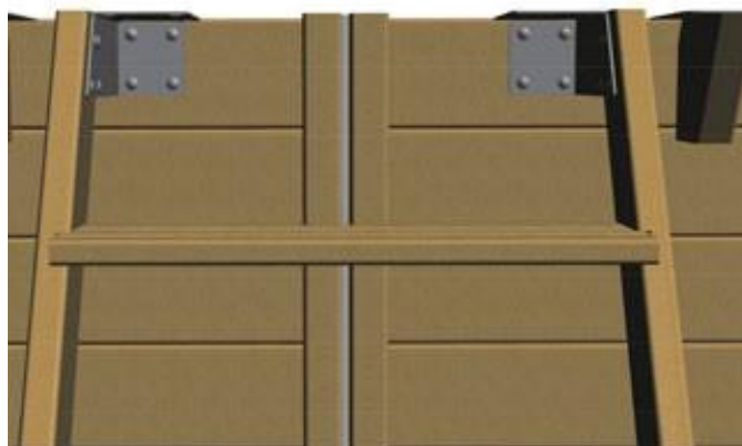
Figure 16 – Fixation de l'escalier extérieur sur le bassin
